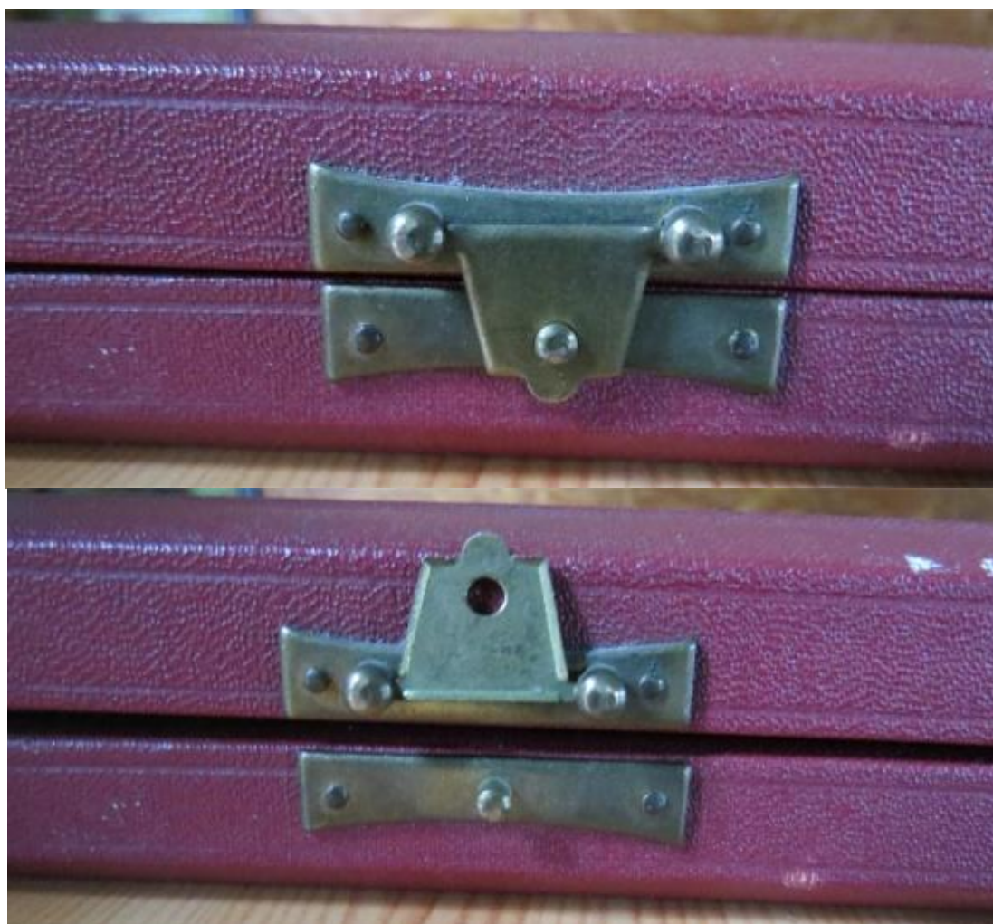
05. – 07. kép - Az előoldali pattintós rögzítők egyike, zárt és nyitott állapotban
